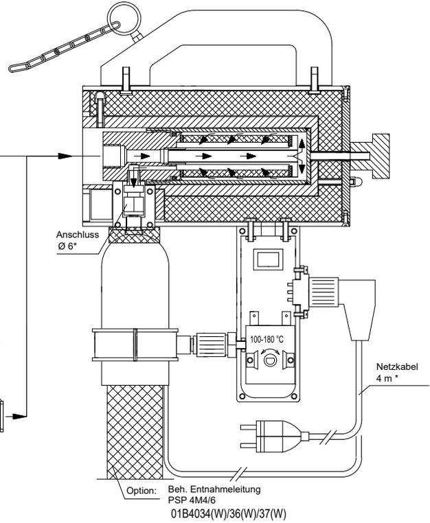
Entnahmeadapter mit variabler Rohrlänge
