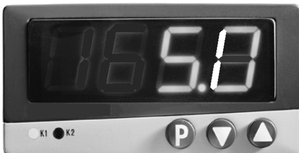
Abbildung 12 Frontansicht des Temperaturreglers bis 03.2022
