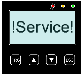
Abb. 8: ‚Service‘-Bildschirm: nicht-bestandener Selbsttest
