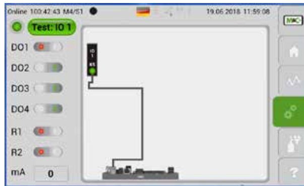
Abb. 66: IO1-Komponenten: DO1 bis 4, Relais-Ausgänge R1, R2 und mA-Ausgang
