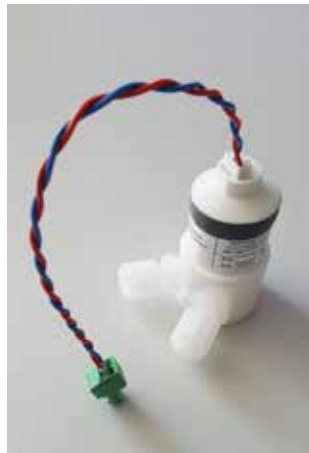
Abb. 4: Elektrochemischer Sauerstoffsensor mit Durchflusskammer
