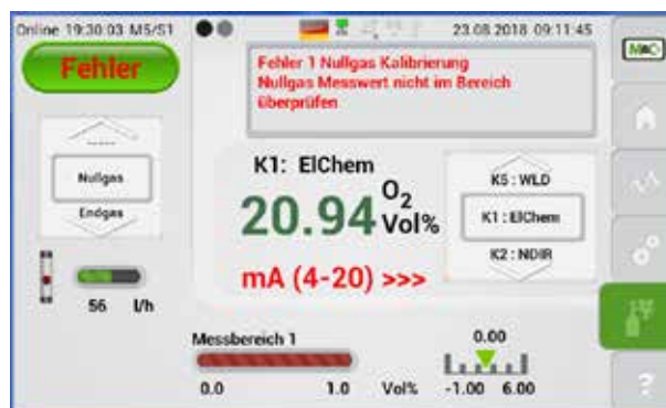
Abb. 83: Fehler bei der manuellen Kalibrierung
