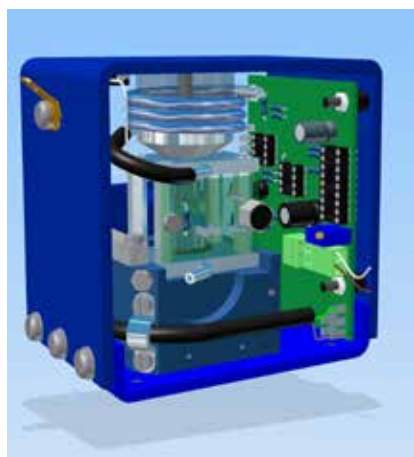
Abb. 2: Beheizter PMA-Transmitter mit Messzelle
