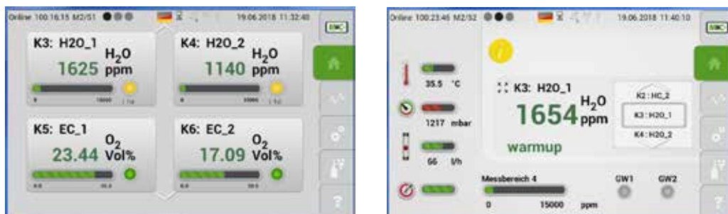
Abb. 72: Bildschirm M2/S1 mit Anzeige (gelbe LED) und M2/S2 in der Aufwärmphase
