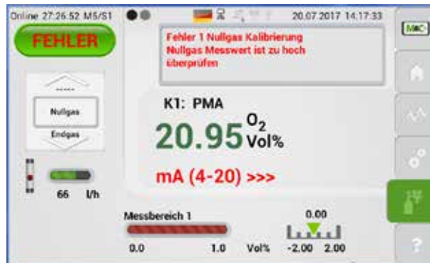
Abb. 75: Fehler bei der manuellen Kalibrierung
