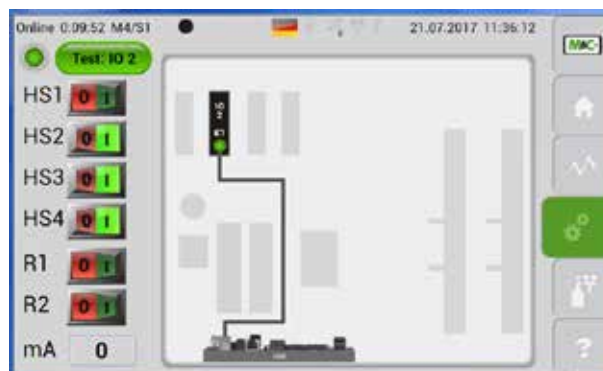
Abb. 56: I/O2-Komponente: High-Side-, Relais-Ausgänge und mA-Ausgang
