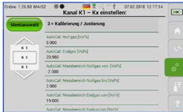
Abb. 85: Einstell-Bildschirm für Messbereich und Konzentration des Testgases
